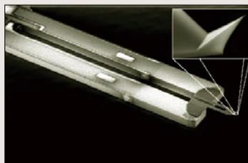
自己励振・自己検出可能な水晶振動子とバネ定数の小さなカンチレバーを組み合わせたプローブ
